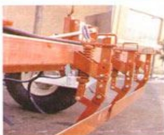
Доска-гладилка разбивает комки земли, выравнивает и нивелирует поверхность почвы.
