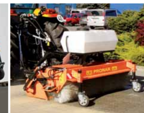
Система орошения для уменьшения пыле- и грязеобразования.
