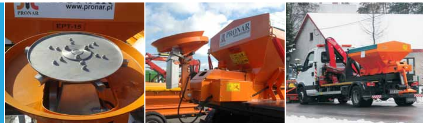
Разбрасывающий диск из нержавеющей стали
