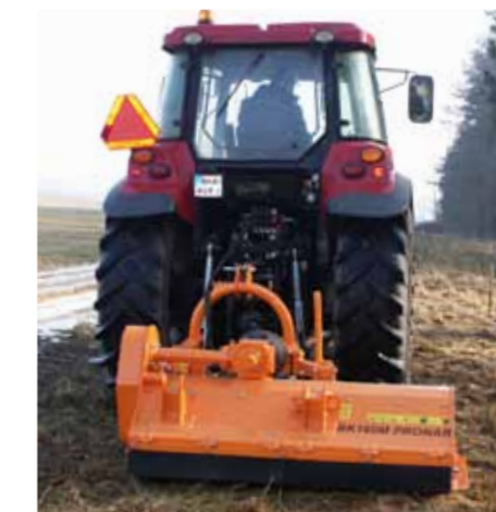
Сдвиг косилки с помощью гидравлики позволяет косить за пределами габаритов трактора
