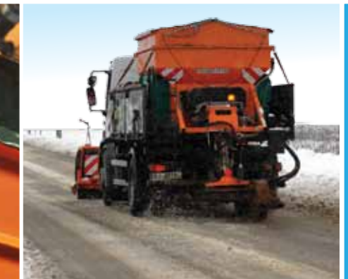
Надставки, увеличивающие размер загрузочного бункера. привод от пассивного колеса.
