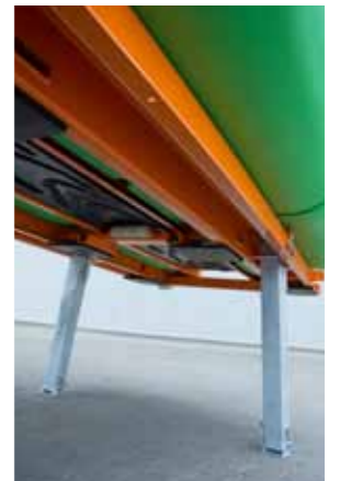
Система для облегчения загрузки пескоразбрасывателей РТ70 на платформу грузовика
