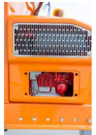
Двигатель внутреннего сгорания объемом 100 см 3 и мощности 16,2 кВт
