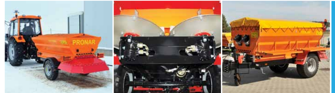
Регулируемая ширина разбрасывания. 2 разбрасывающих адаптера из нержавеющей стали. Боковая площадка для обслуживания
