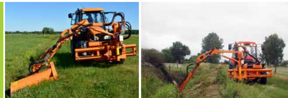
Стрела WWP500 с модулем для кошения GK140
