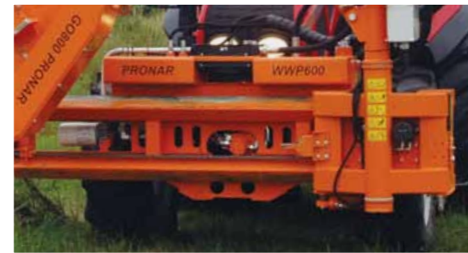
Стрела WWP600 – перемещение рабочего плеча по направляющей при помощи гидравлики.
