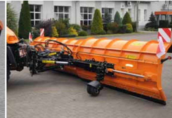
Способ крепления - коммунальная плита DIN 76060 тип А
