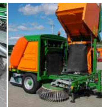
Опустошение бункера гидравлически.
