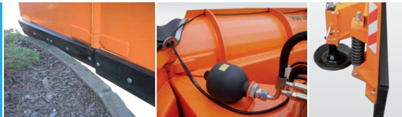
Защитный пружинный механизм (подвижные ножи отвала)
