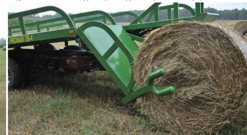
Гидравлический механизм загрузки поднимает рулон и направляет его на прицеп
