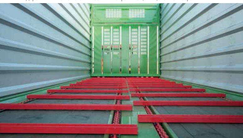
Деревянный пол с металлическими направляющими цепей конвейера
