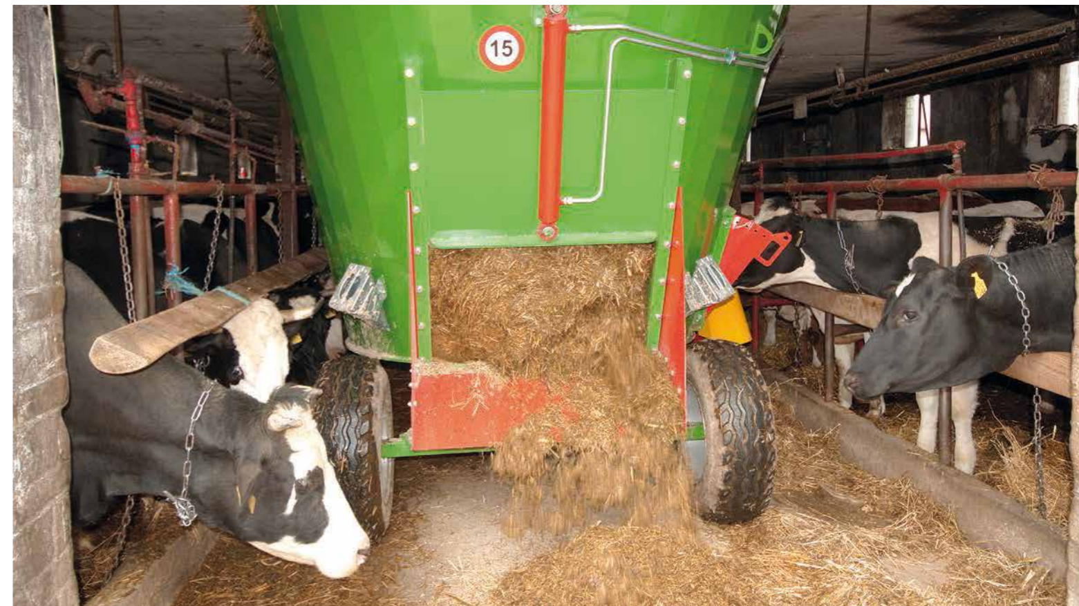
PRONAR VMP-5ST – два выгрузочных окна с лотками: боковые окна спереди с правой стороны и сзади (на фото)
