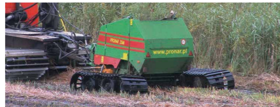
Пресс-подборщик PRONAR Z500G - на гусеничном ходу позволяет выполнять работы на затопленных и заболоченных территориях
