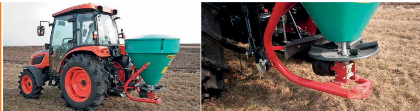
Разбрасыватель PRONAR FD1-M05 объемом 500 дм 3
