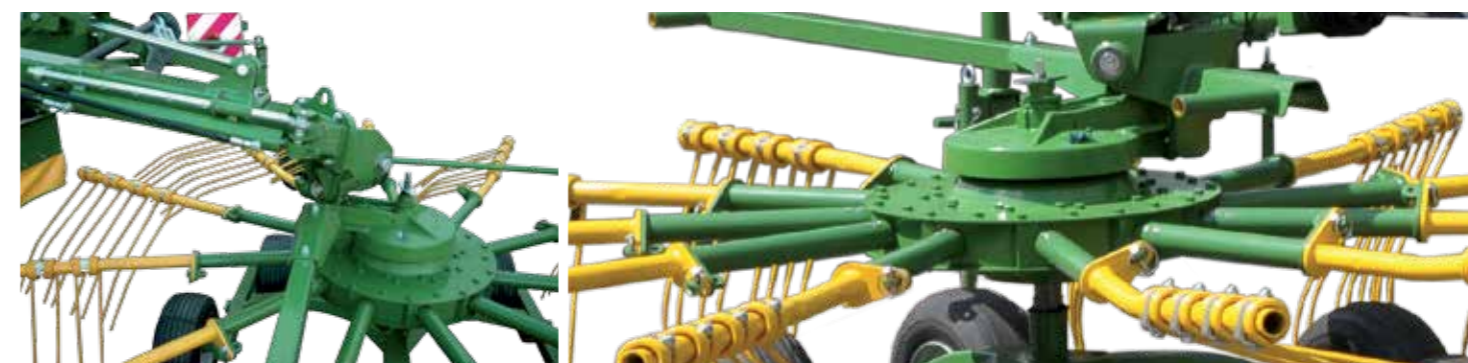
Гидроцилиндры регулирующие рабочую ширину граблей- 7-8 м
