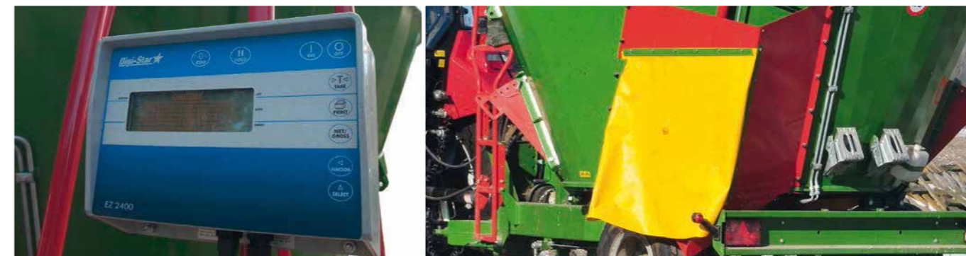
Дисплей для контроля веса компонентов корма и времени работы
