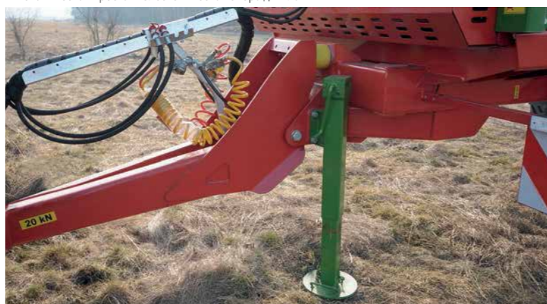
Механическая простая телескопическая опора дышла
