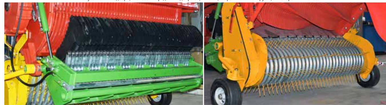
Кулачковый подборщик с семью рядами подбирающих пальцев с роликом и копирующим поворотным колесом
