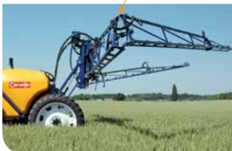
Двойная механическая защита за срезных болтов
