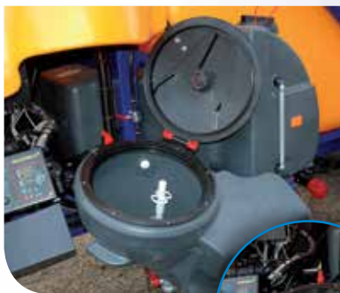
Бак-смеситель с миксером и пистолетом для промывки канистр
