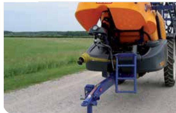
Трап с защитой от скольжения
