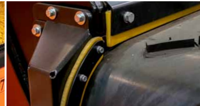
Уплотнения в бункере защищают от проникновения исходного материала в машину.
