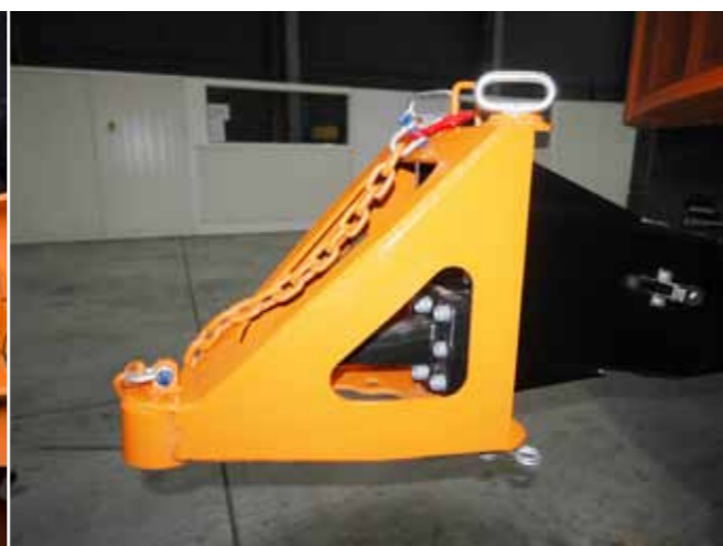
Шаровая приставка позволяет перемещать просеиватель с помощью строительной техники.
