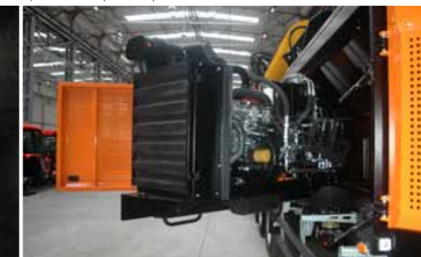
Двигатель и гидравлическая система размещаются на поворотной раме, что обеспечивает удобный доступ при проведении сервисных работ
