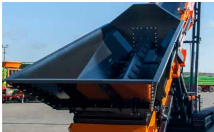
Прямой зарядный бункер для работы с погрузчиком
