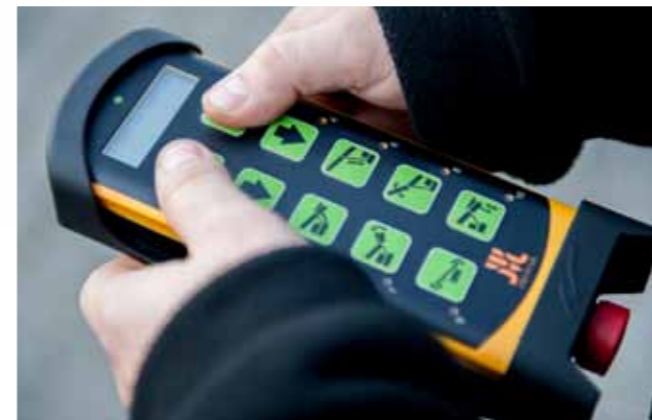
Беспроводное управление позволяет перемещать и позиционировать машину в рабочем положении
