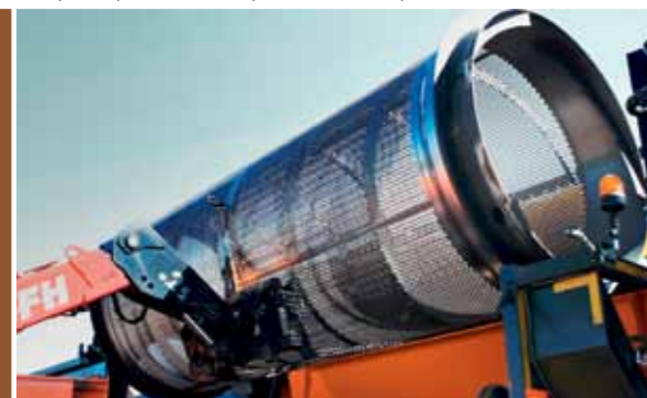
Быстрая и простая замена просеивающего барабана.
