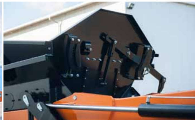
Засов хоппера предотвращает слишком быстрому сливанию материала из бункера
