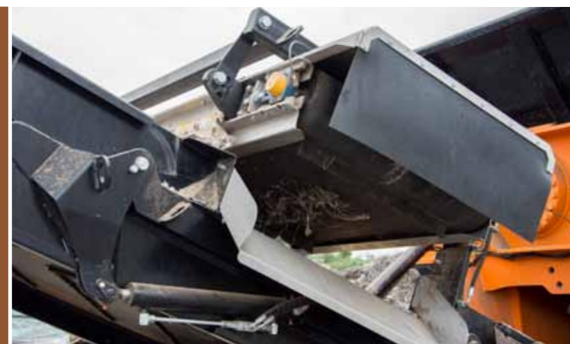
Гидравлически регулируемый магнитный сепаратор для отделения ферромагнетиков.
