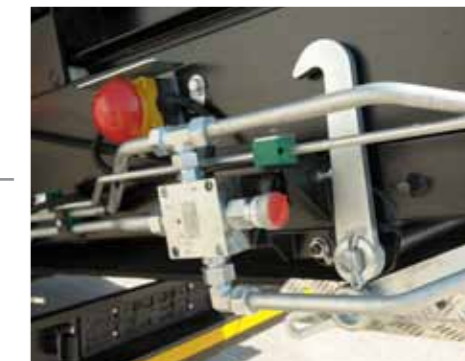
Регулирование скорости передвижения ленты подающих механизмов позволяет подобрать скорость в зависимости от типа просеиваемого материала таким образом, чтобы максимально использовать производительность мобильного барабанного просеивателя. Также позволяет насыпать большое количество материала каждой фракции без необходимости перемещения машины.
