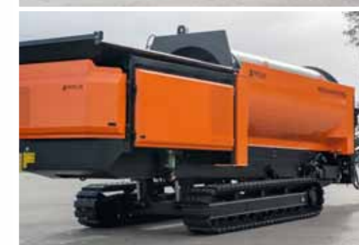
Гидравлически подъемная рама позволяет MPB 20.55gh выровнять машину для работы на склонах и увеличивает дорожный просвет для облегчения преодоления пересеченной местности.
