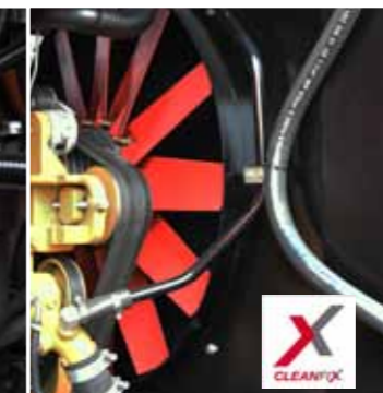
Система Cleanfix автоматически очищает радиатор двигателя и радиатор гидравлического масла.
