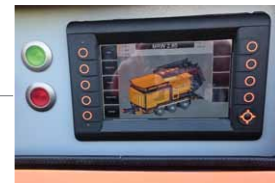
Сенсорная панель управления всеми функциями машины.
