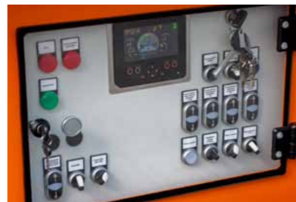
Функциональная панель управления позволяет контролировать и устанавливать параметры конвейера
