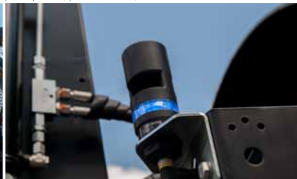
Многофункциональный проблесковый маячок указывает на режим работы (просеивание/езда).
