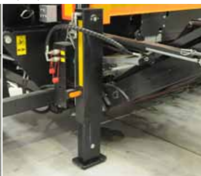
Гидравлические задние опорные ноги повышают комфорт работы оператора и устойчивость машины во время работы.
