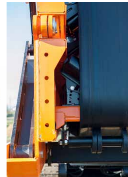
Возможность изменения угла наклона рулонов, поддерживающих ленту, для формирования потока передаваемого материала (изменение профиля ленты)
