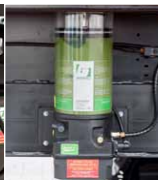
Центральная система смазки обеспечивает хорошее состояние наиболее важных элементов машины. Имеется в двух размерах.
