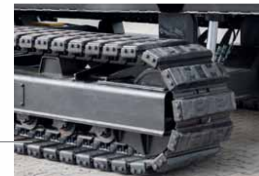
Гидравлически подъемная рама позволяет MPB 20.55gh выровнять машину для работы на склонах и увеличивает дорожный просвет для облегчения преодоления пересеченной местности.
