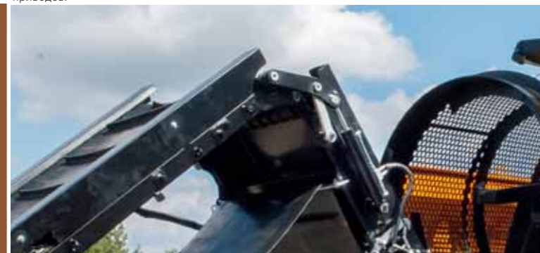
Задний конвейер складной с помощью четырех гидравлических приводов.
