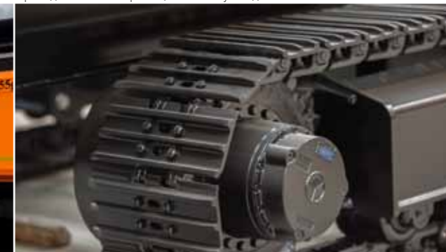
Привод позволяет перемещать машину без дополнительных тягачей.
